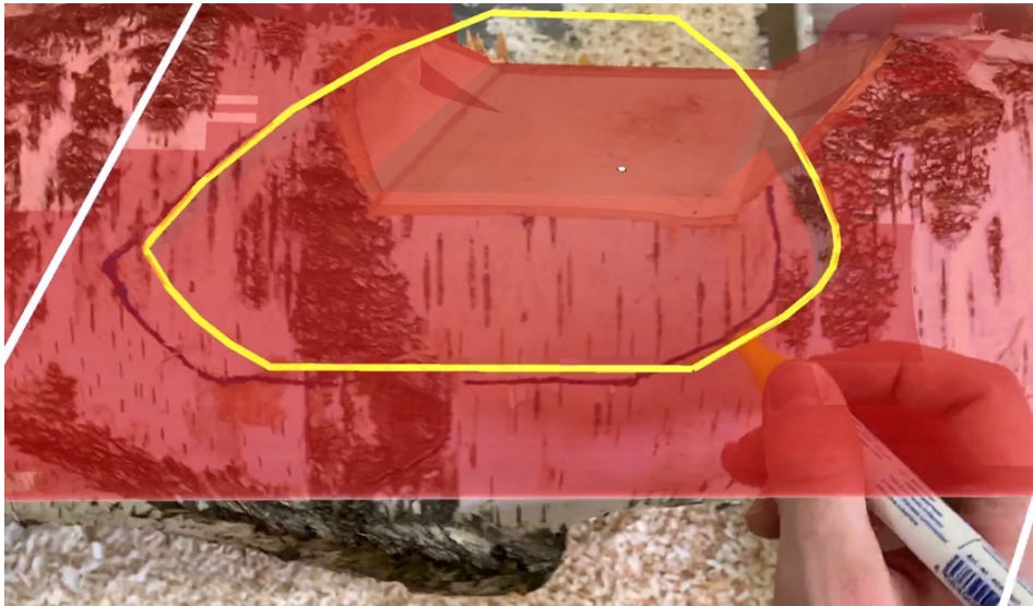
Figure 65 : Limite de découpe projetée avec Fologram
