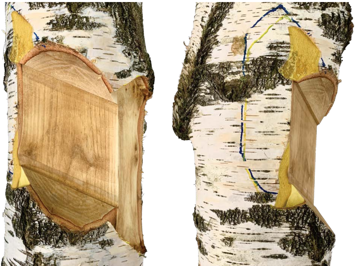
Figure 23 : Défaut d'usinage lors des premiers essais
