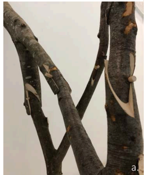
Figure 15 : Log Knot et principe d'assemblage
