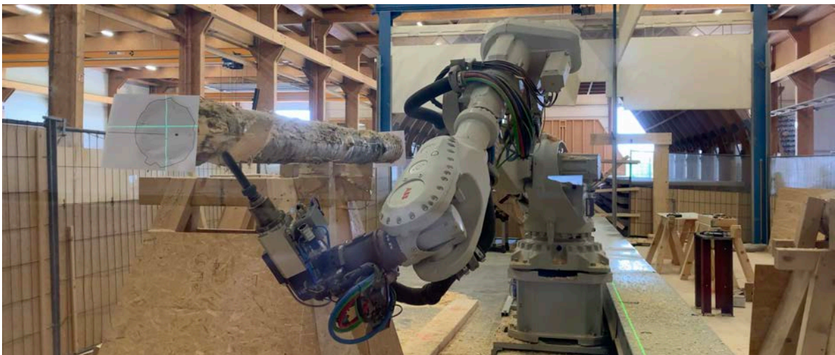
Figure 80 : Positionnement de la grume par rapport au robot
