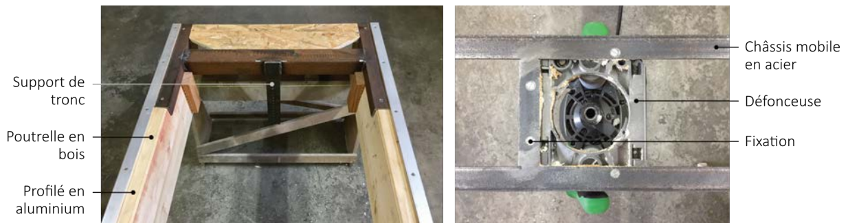
Figure 58 : Détails du banc d'essai. Support de tronc, à gauche. Installation du châssis mobile sur la défonceuse, à droite
