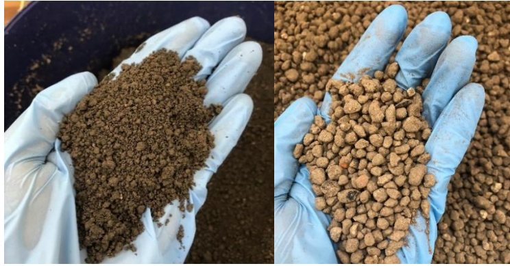
Figure 16 : fraction de terre inférieure (à gauche) et supérieure (à droite) à 4mm
