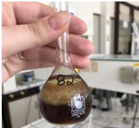
Figure 32 : solution résultante de l'extraction Soxhlet et du rotavapor présentant un comportement biphasique
