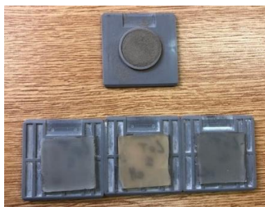
Figure 22 : échantillon sous forme de poudre sur un porte échantillon (en haut) et sous forme de dépôt argileux sur lame de verre (en bas)
