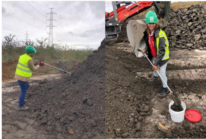
Figure 15 : prélèvement de sols pollués dans un centre de traitement des terres
