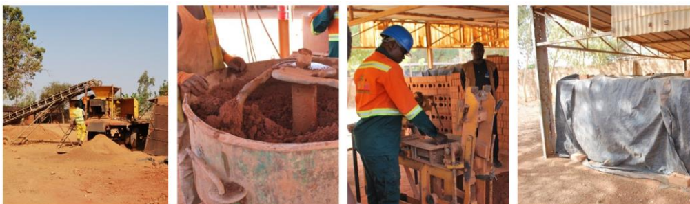
Figure 2-13 : Etape de production des BTC
