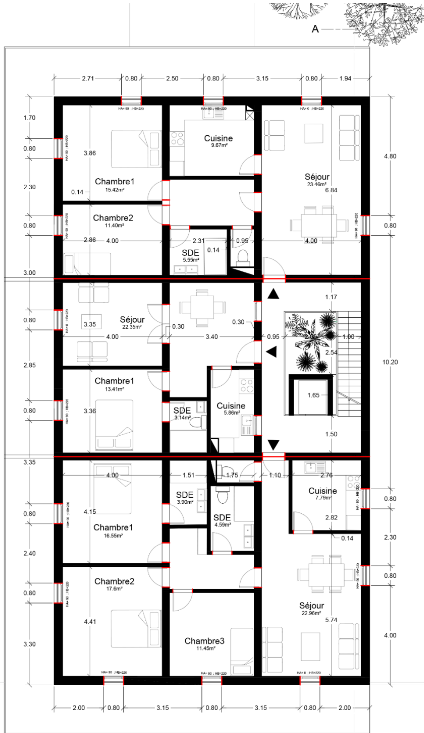
Figure 5-9 : Plan des étages avec joint de dilatation de l'Archétype 1 et 2
